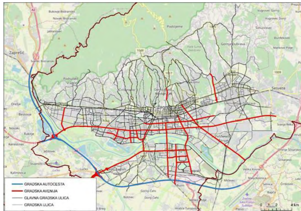
Slika 25 Kategorizacija cesta na prostoru Grada Zagreba (preuzeto iz Master plana prometnog sustava Grada Zagreba, Zagrebačke županije i Krapinsko-zagorske županije, 2020.)
