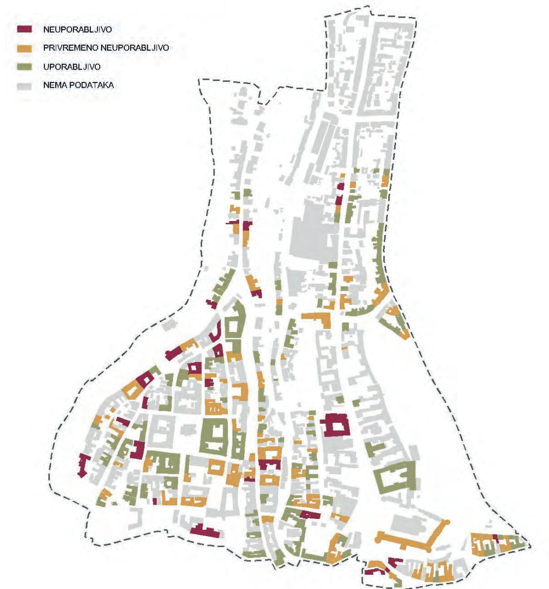
Sl. 53. Stanje zgrada nakon potresa
