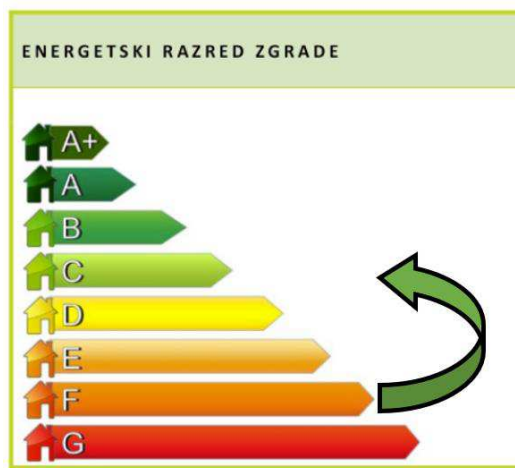
Slika 16 Energetski razred zgrada Bloka-19 prije i nakon obnove
