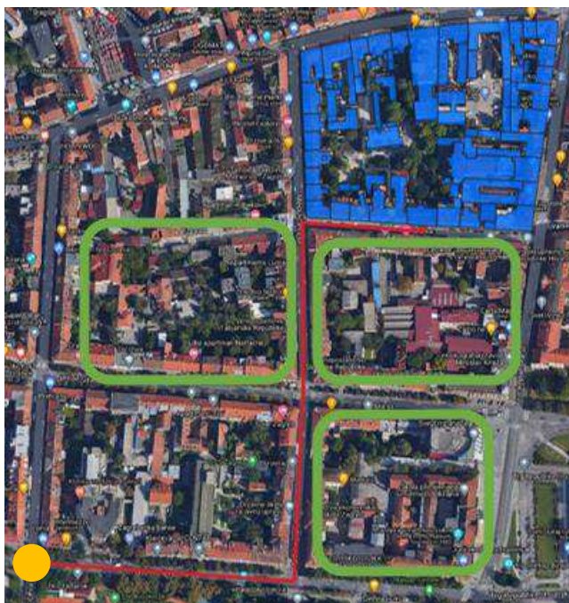
Slika 17 Lokacija potencijalnog spajanja na postojeći parovod (narančasto) , prijedlog širenja toplinske mreže (crveno) i lokacija dodatnih blokova (zeleno) za potencijalno spajanje
