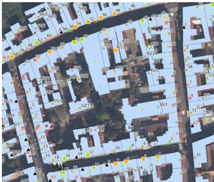
Slika 4.8 Prikaz procjena uporabljivosti zgrada u bloku 19 nakon potresa u Zagrebu (prozirne oznake uporabljivosti) i potresa kod Petrinje (neprozirne oznake uporabljivosti)
