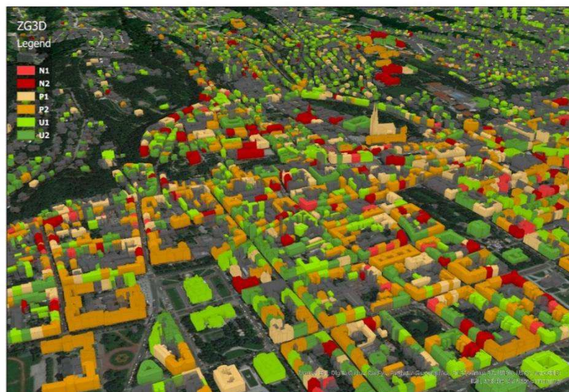
Slika 4.4 3D prikaz zgrada Donjeg grada i Gornjeg grada prema boji procjene uporabljivosti nakon potresa u Zagrebu
